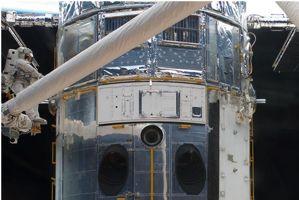
Слика 26 – уградња WFPC 3 током CM4
